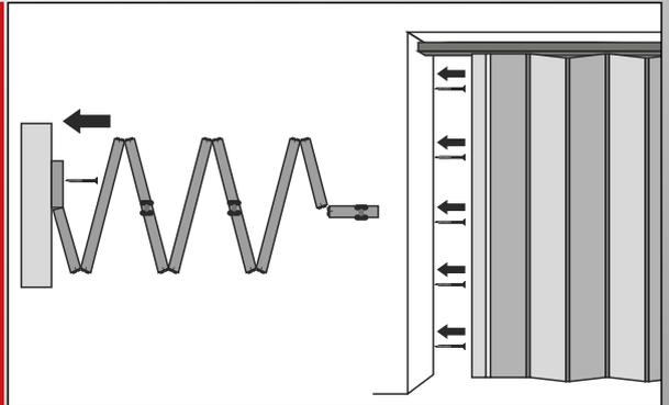
Fije la parte trasera de la puerta al costado de la abertura mediante tornillos con tarugos.
