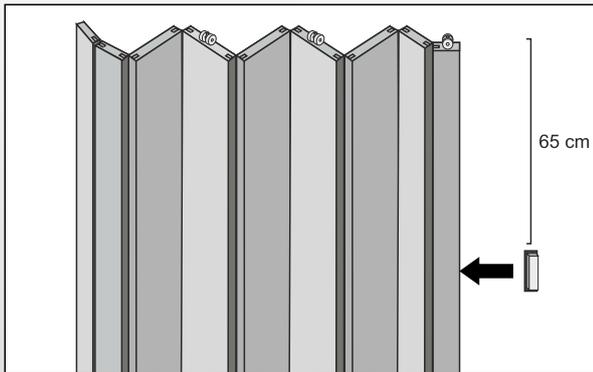
Coloque las MANIJAS con los tornillos provistos en la HOJA a 65 cm de la parte superior.
