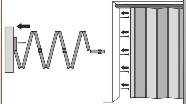
Fije la parte trasera de la puerta al costado de la abertura mediante tornillos con tarugos.
