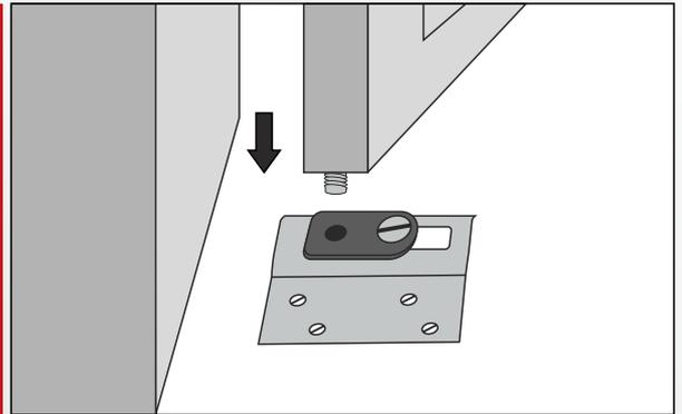
Coloque el pivote inferior sobre su base. El pivote inferior puede ser desenroscado para asegurar el calce en la base de ser necesario.
