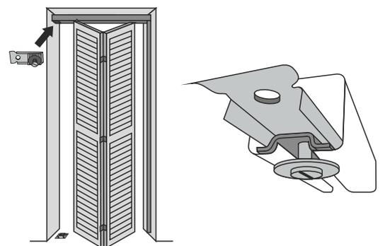
Coloque la base del pivote superior dentro de la GUÍA metálica, como se muestra en la figura, y ajuste suavemente el tornillo.
