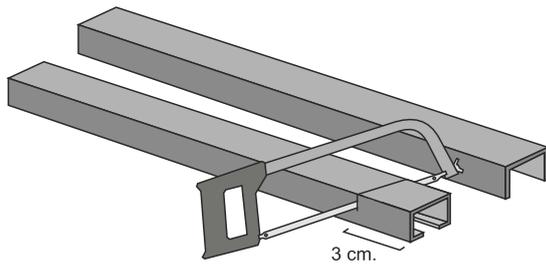
Corte el CUBREGUÍA a la medida del ancho de la abertura. Cortar la guía metálica 3 cm. menos que el cubreguía.
