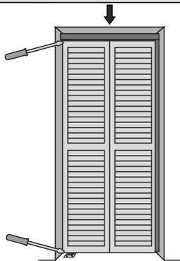
Cierre la puerta y centre la unión de las hojas con la abertura y ajuste los tornillos de las bases.
