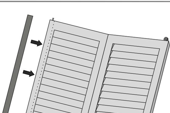
Retire la puerta de la guía descalzando los pivotes. Clave las varillas a la puerta en las marcas previamente hechas.
