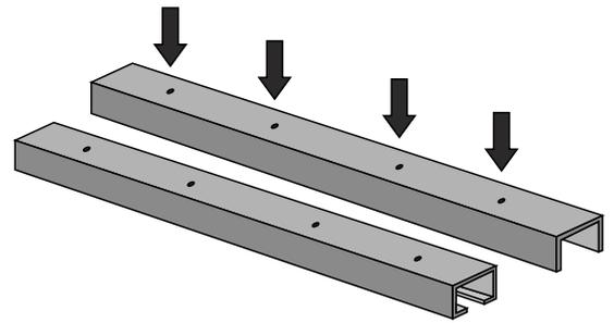
Realice en ambas piezas las perforaciones necesarias que servirán para pasar los tornillos que se fijarán a la parte superior de la abertura mediante tarugos.
