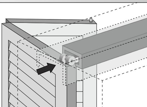
Coloque el carro de la HOJA dentro de la GUÍA metálica.
